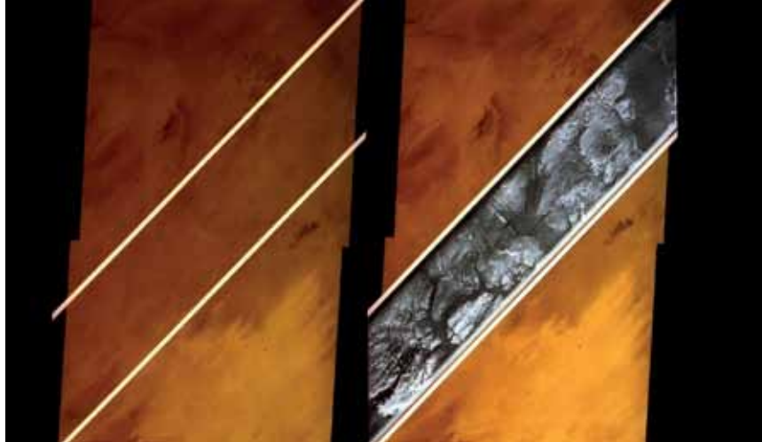
Abb. 1: Landsat MSS Bild (links) überlagert mit einem Shuttle-Radar (SIR-A) Bildstreifen (rechts). Auf den Satellitenbildern ist ein Bereich der Region Darfur in NW-Sudan dargestellt. Die Radiowellen penetrieren den trockenen Wüstensand und machen darin begrabene Flusslandschaften sichtbar. Der Radarstreifen ist etwa 40 km breit. Quelle: Elanchi & Granger 1982
