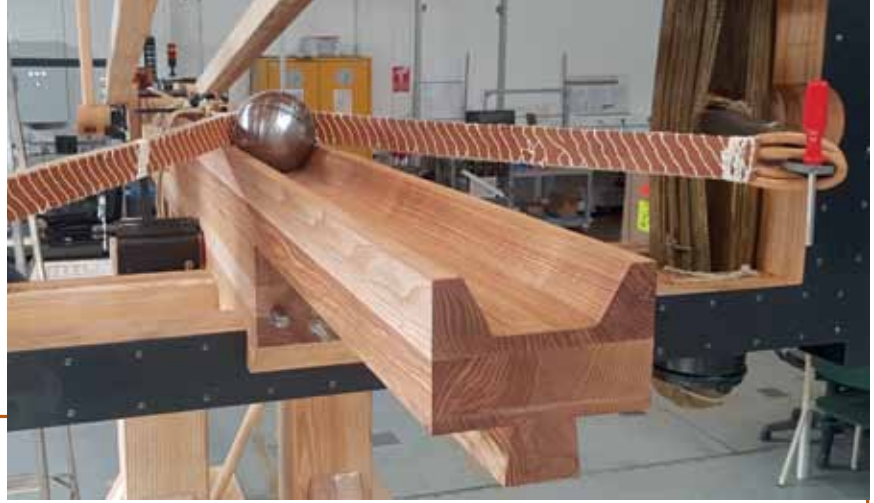
Abb. 1: Frontansicht des Hatrageschützes mit Sehne und 2,6 kg schwerer Kugel. Foto: David Ginster
