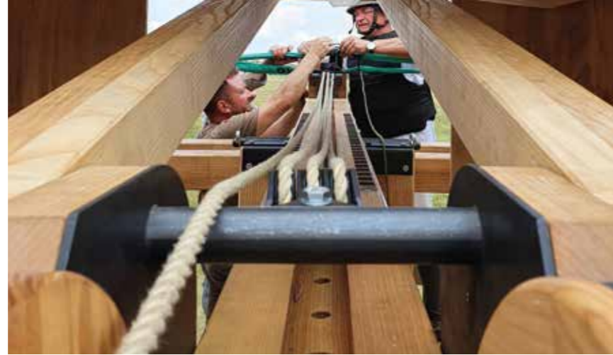
Abb. 4: Dreifach-Flaschenzug/Umlenkrolle zum Spannen des Geschützes
