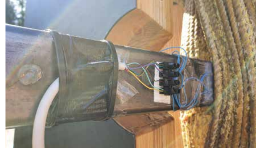
Abb. 5: Kräftemessung im Metall durch DMS
