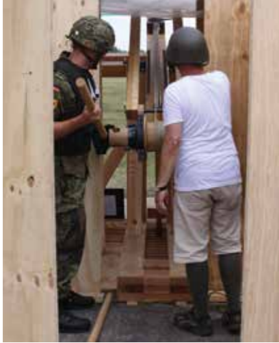
Abb. 3: Sicherheitswände zum Schutz der Bedienermannschaft.
